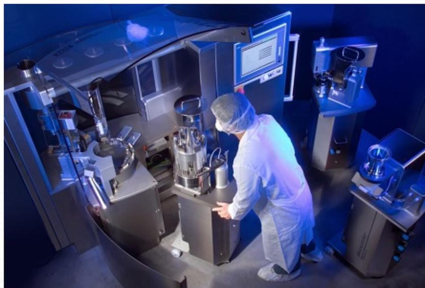
藉由膠囊充填設備(Harro Höfliger Modu-C MS)專屬雙充填設計，降低兩種微粒混合的風險，確保二種微粒精準充填，藥物的均一度更佳。
